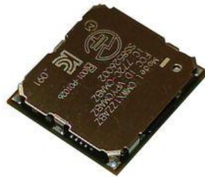
Figure 99 : Module intégrant stack LoRaWAN et Transceiver
