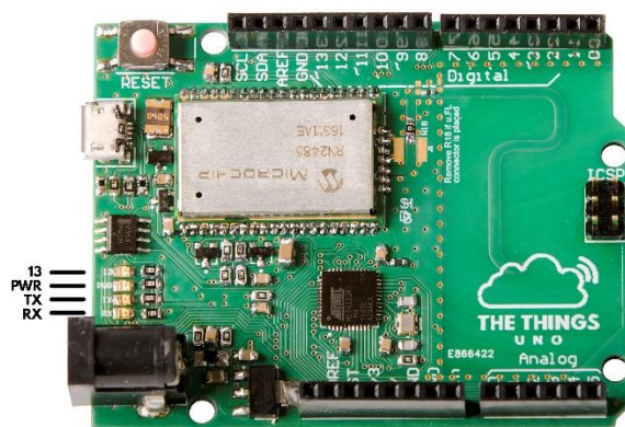
Figure 103 : Microcontrôleur ATMEGA + Module RN2483
