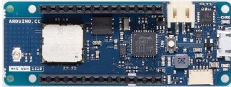
Figure 104 : Microcontrôleur ATMEL + Module CMWX1ZZABZ
