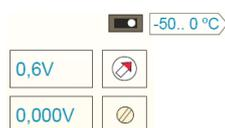
6. À l'aide du simulateur Pt100, sélectionnez la valeur de température de fin d'échelle souhaitée.
