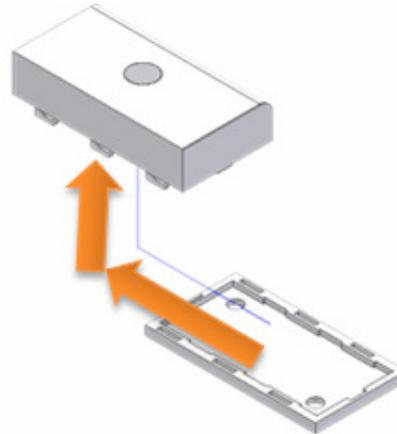
Repérer la position des trous et percer le mur en prenant en compte votre système de fixation (cheville + vis). Enfoncer les chevilles dans les trous percés précédemment. Positionner le support afin que le côté arrondi du ZDOOR soit orienté vers le mur puis visser les vis comme sur la photo.
