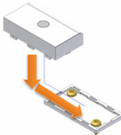
Procéder ensuite à la pose de l'aimant sur la porte. Positionner l'aimant sous le ZDOOR comme indiqué sur la photo en laissant une distance **maximum** entre l'aimant et le ZDOOR de 6mm. Une fois l'aimant positionné correctement, repérer la position des trous.
