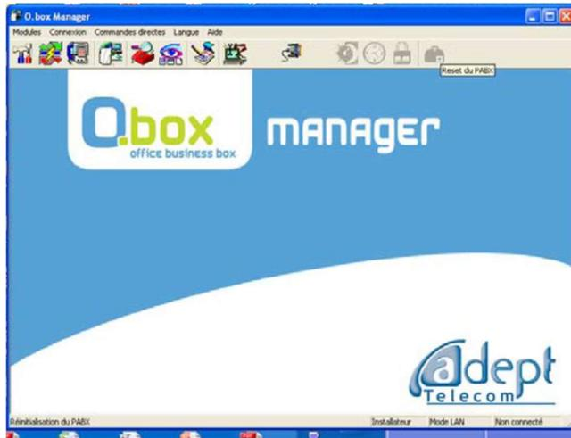
Lorsque l'autocommutateur O.BOX est en configuration usine son adresse IP est : 192.168.1.1.
