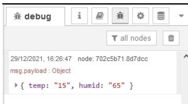
⇒ Lancer la requête http ci-dessous (modifier l'IP Raspberry) et observer le message dans la fenêtre debug.
