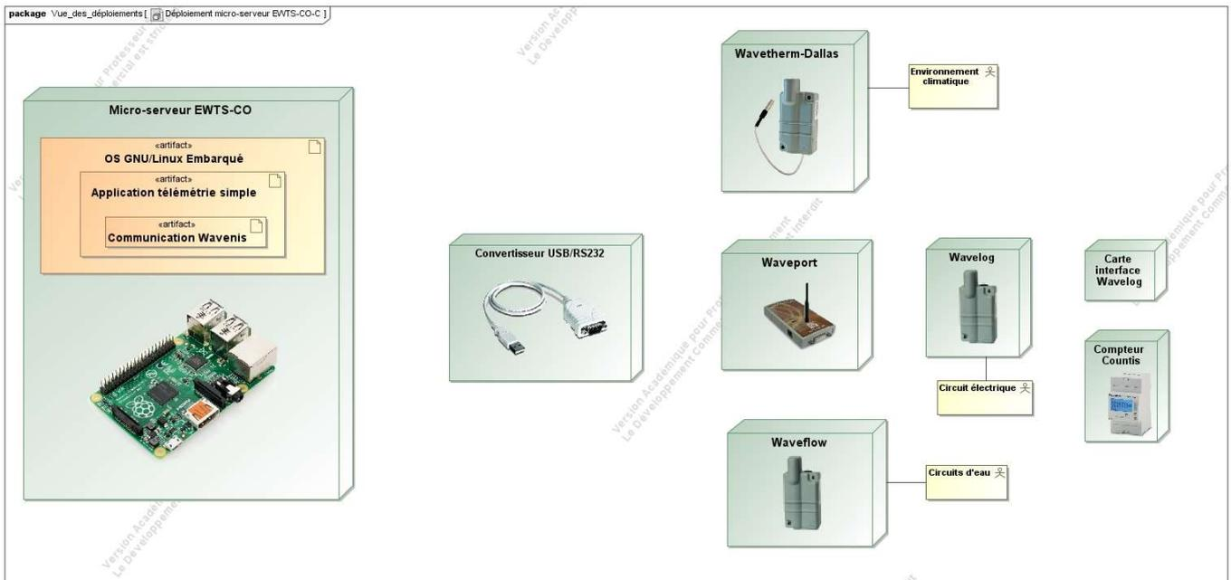
La carte interface Wavelog permet d'adapter les impulsions fournies par le compteur au capteur Wavelog.
