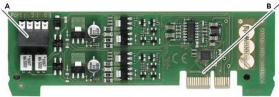
A - 4 bornes pinces (ports internes 5-6) pour le raccordement de terminaux analogiques, deux bornes de raccordement par port.
