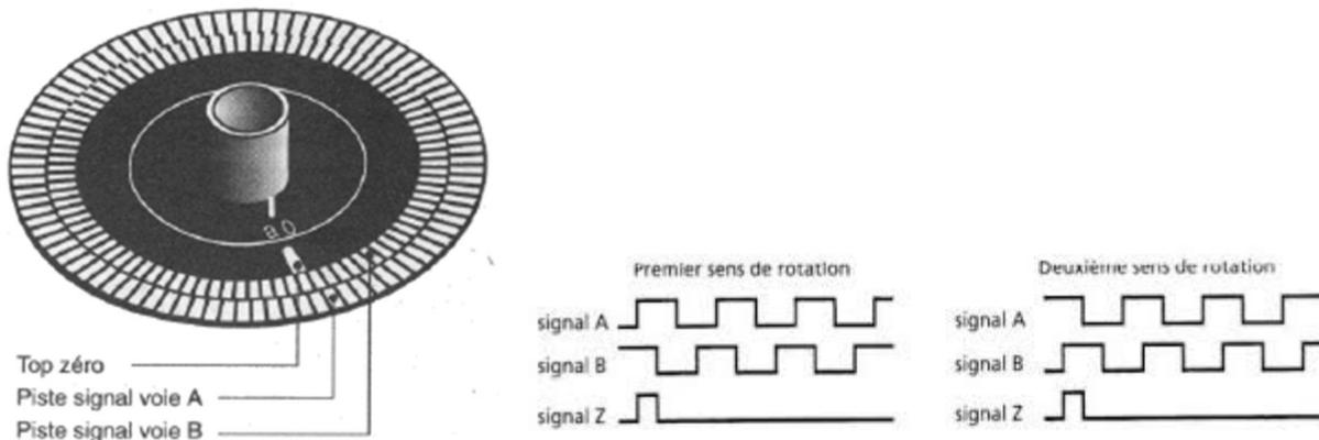
Un codeur incrémental dispose de 2 pistes et délivre 2 signaux : A et B.
