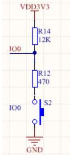
GPIO0 doit alors être configuré en entrée. L'appui sur le bouton poussoir fournit un niveau bas.
